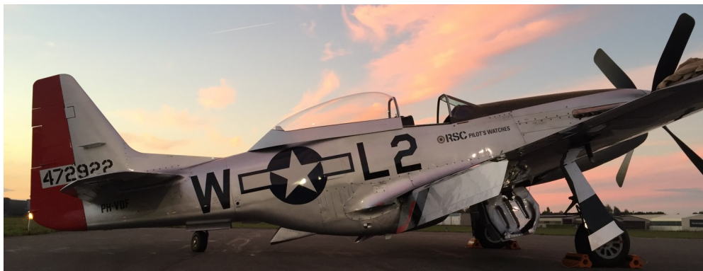
Vista lateral do P-51D com alguns detalhes bem visíveis como o flap em baixo, as pequenas portas da roda de cauda e o rear scoop aberto que permite melhor arrefecimento - Foto: Carlos Tomaz
